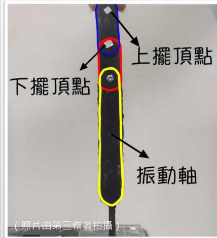
圖2 雙擺裝置圖 (螺絲以下為振動基座)
