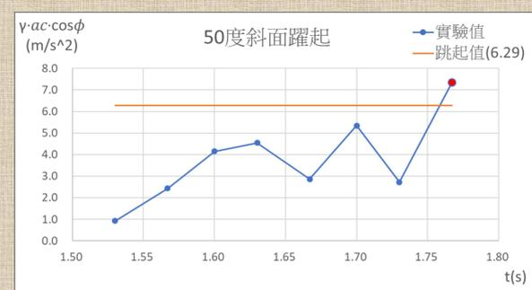
圖(十)實驗值隨時間變化圖：50度斜面
