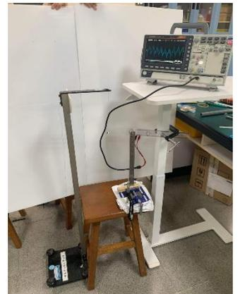
2. 敲擊鐵尺 4.3cm(駐波中得第 7 諧波)(考慮能量衰退，並將實驗定量)
