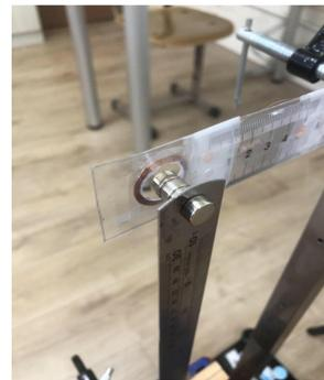
左圖為線圈特寫，在佈置磁鐵時，磁鐵置於線圈中間，並且剛好通過線圈
