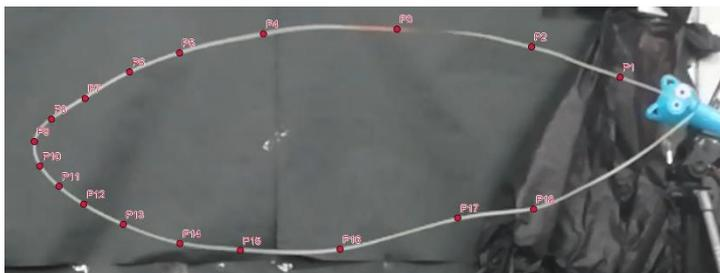
(7) 速度  $v = 580.7 \text{ cm/s}$ ，單位長度空氣阻力  $f = 13.8 \text{ dyne/cm}$
