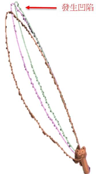
圖 9 當速度增加時，繩圈會上升，且在末端發生凹陷。(圖片來源：實驗者拍攝並後製)
