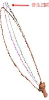
圖8 隨著速度增加繩圈末端發生凹陷
