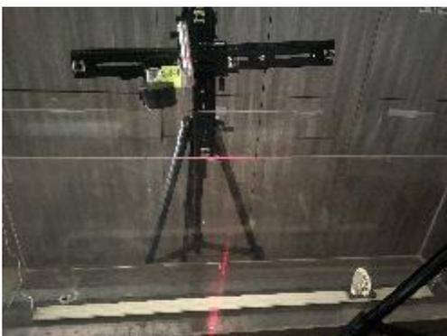
改變測量視深位置的投影幕，在座標控制器上有一直角可定位雷射反射之交點，圖下方為控制觀測物位置滑軌
