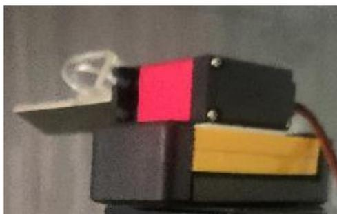
利用舵機轉動反射鏡以改變雷射入射角度不須移動雷射原位置，處可利用光槓桿原理計算雷射入射角度
