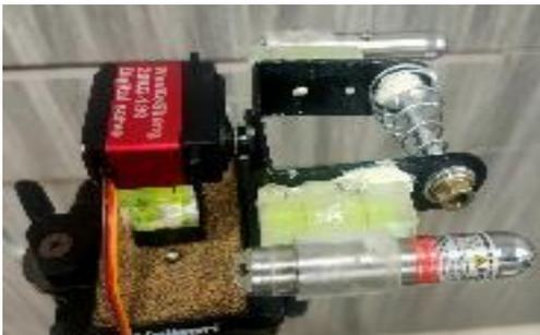
雷射改由舵機控制轉動方向，以利研究由平視漸變為側視觀測姿勢，並由前面螺絲調整雷射交會點
