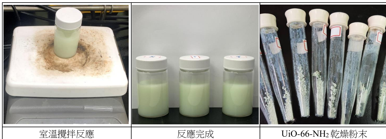
圖 9. UiO-66-NH 2 合成步驟(本照片為作者/指導老師拍攝。)
