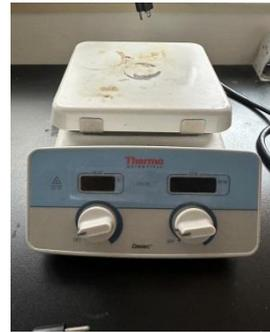
圖 3-4 電磁加熱攪拌器
