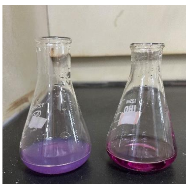
圖三十五、鋅鈣溶液滴定 EDTA 前 （左側為加入硫化鈉之溶液） （研究者拍攝）
