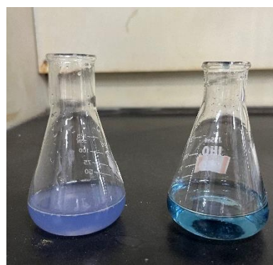
圖三十六、鋅鈣溶液滴定 EDTA 後 （左側為加入硫化鈉之溶液） （研究者拍攝）
