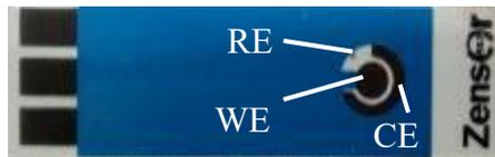
圖3-3 網版印刷石墨三電極(自繪)
