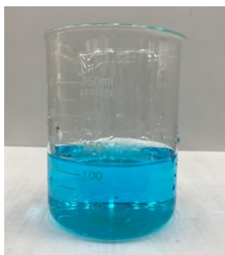
(圖4-10) 硫酸銅溶液電解後 (圖4-11) 硫酸銅溶液石墨棒電解後 實驗結果與討論：以3.0V電壓電解15分鐘後在陰極有少量銅析出
