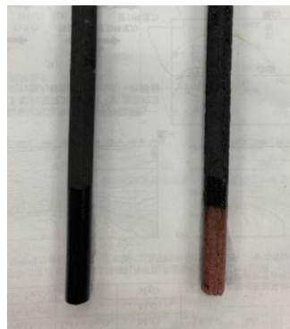
(圖4-10) 硫酸銅溶液電解後 (圖4-11) 硫酸銅溶液石墨棒電解後 實驗結果與討論：以3.0V電壓電解15分鐘後在陰極有少量銅析出
