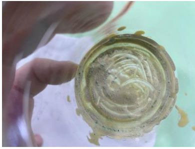
圖64：溶於調合漆中鉍鹽失去變色能力
