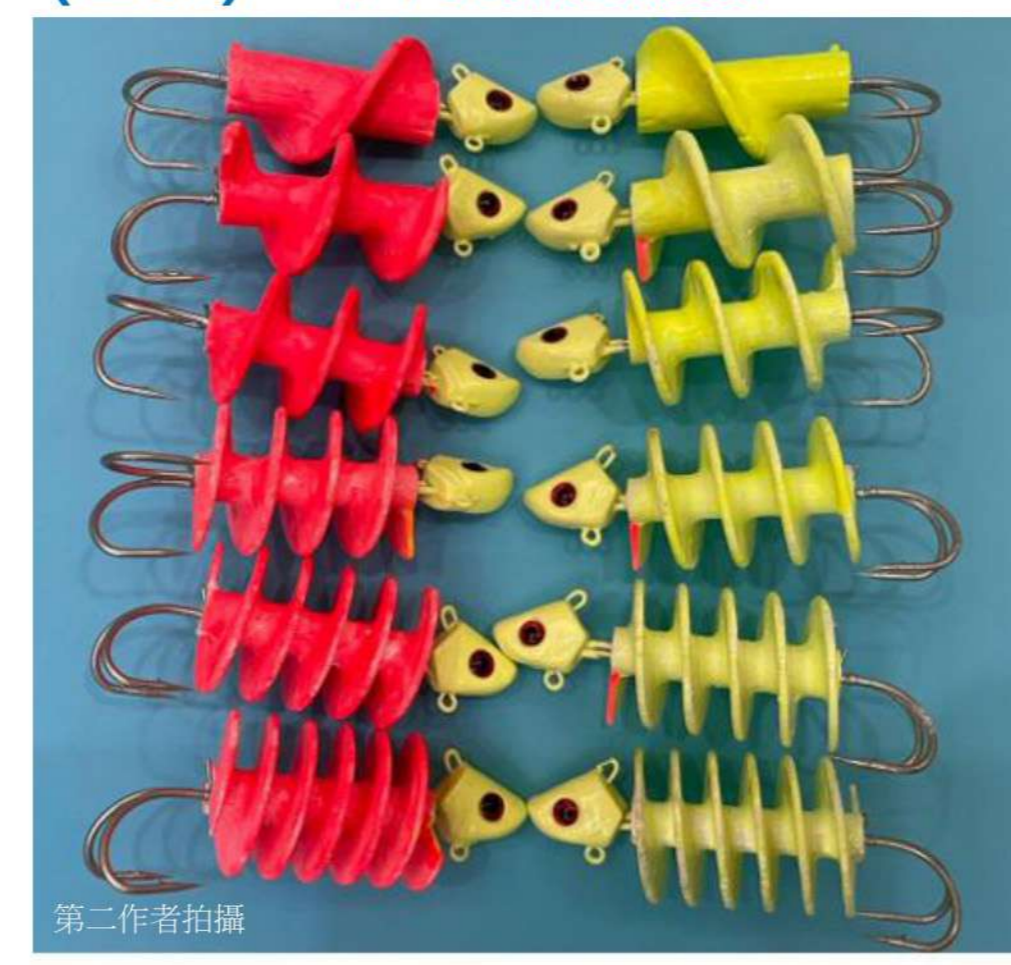
圖 4-28 螺旋天亞 1.0，右旋 1-6 圈(綠色)，左旋 1-6 圈(紅色)
