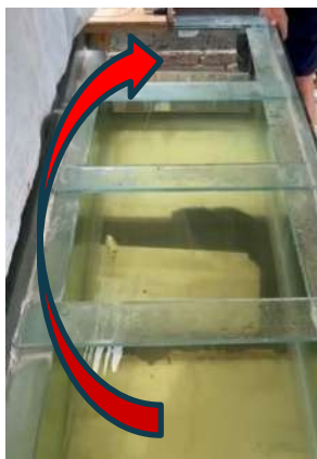
圖 5-19 模擬岸拋： 螺旋式天亞 2.0 右 旋時，其路徑會向 左偏移
