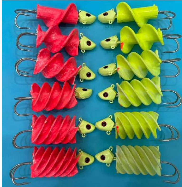
圖 4-29 螺旋天亞 2.0，右旋 1~6 圈(綠色)，左旋 1~6 圈(紅色)
