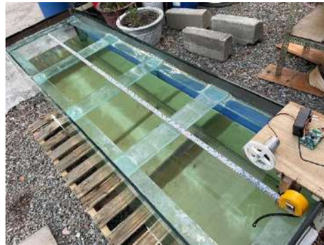
圖 4-31 測量天亞在大水缸落水的水平距離
