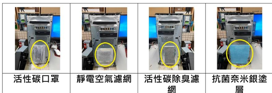
(二)結果：風扇進風口加裝活性炭口罩細懸浮微粒測量值平均：799.7 ug/m3，過濾細懸浮微粒效果最佳。
