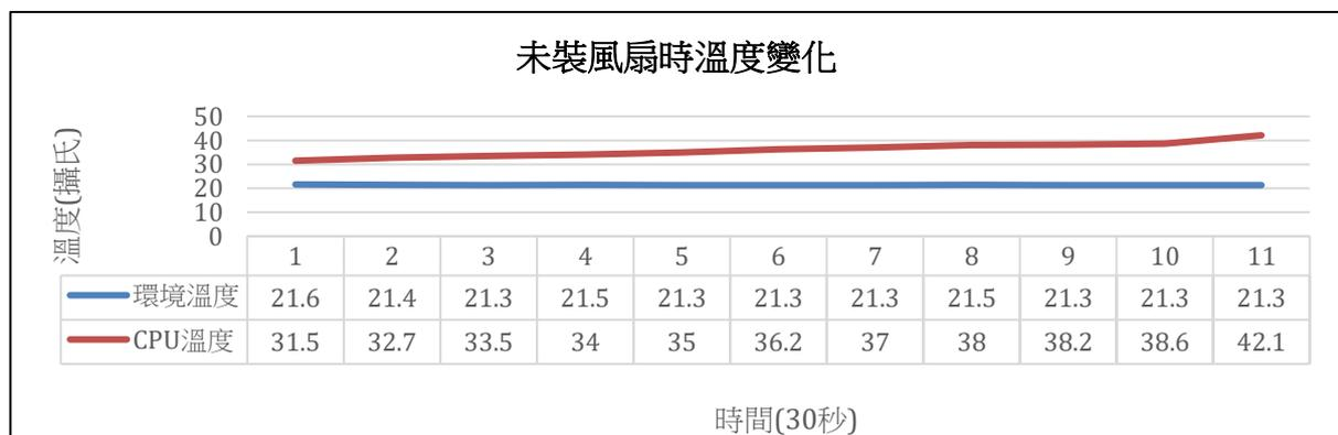
圖十四 未裝風扇時 CPU 溫度變化圖
