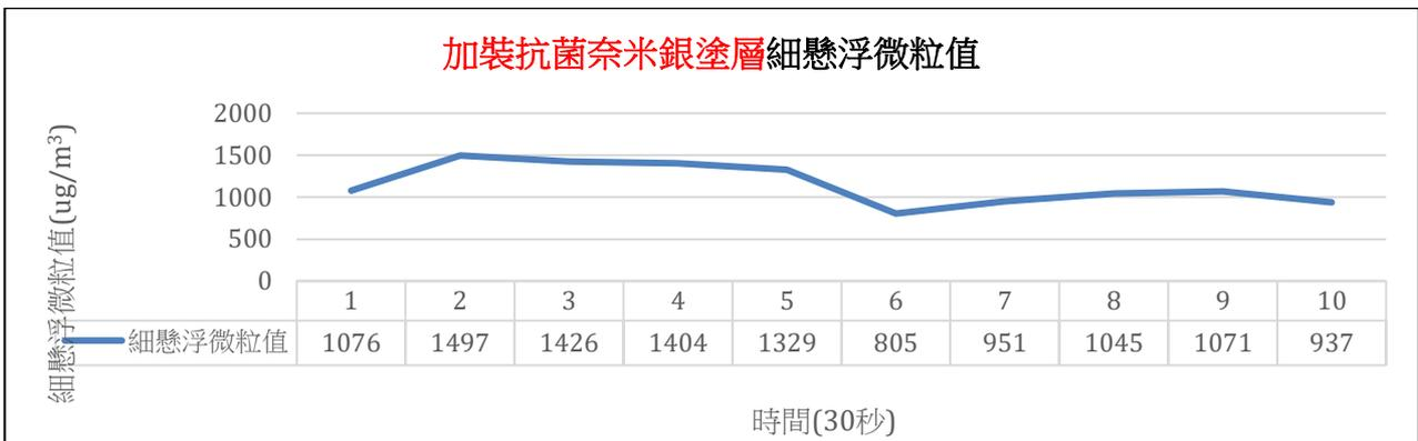
圖二十二 風扇進風口加裝抗菌奈米銀塗層細懸浮微粒值變化圖
