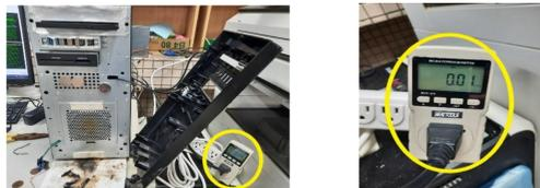
圖1 積塵耗電量測量圖(此圖由第一指導老師拍攝)
