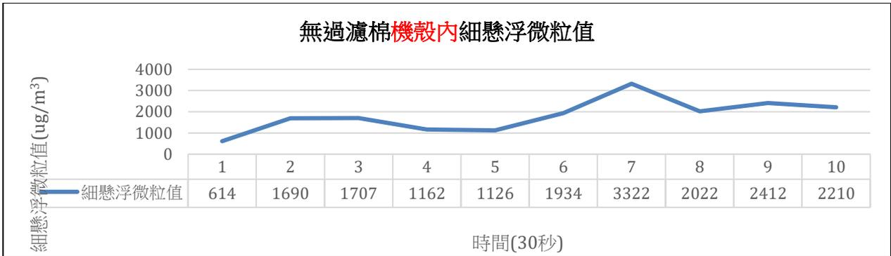
圖十七 風扇進風口無過濾棉時機殼內細懸浮微粒值變化圖
