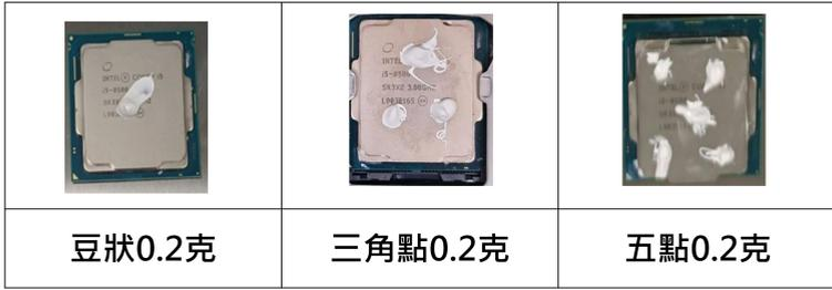
(二)結果：0.2克五點散熱膏；CPU平均溫度83.5°C，降溫最大。
