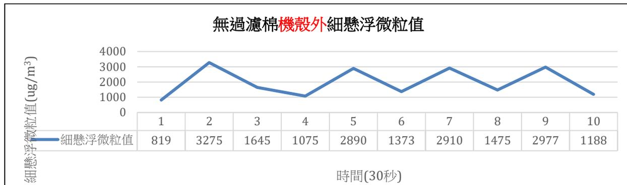
圖十八 風扇進風口無過濾棉時機殼外細懸浮微粒值變化圖
