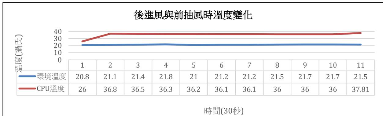
圖十六 後進風與前抽風時 CPU 溫度變化圖
