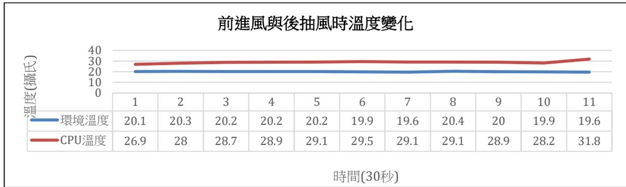
圖十五 前進風與後抽風時 CPU 溫度變化圖
