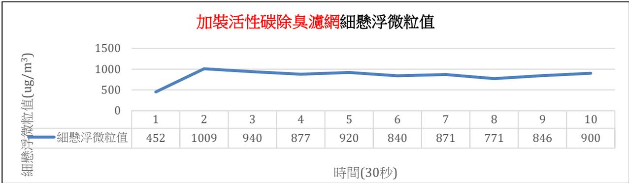
圖二十一 風扇進風口加裝活性碳除臭濾網細懸浮微粒值變化圖
