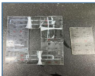
照片 16 將塑膠尺裁剪並拼成中央留有一 5 * 1.5 \text{ cm}^2 的空洞形狀，以膠帶
