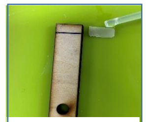
照片 19 剪成 0.5 * 1.5 \text{ cm}^2 ，滴水潤濕膜片，使其黏合在木片。上
