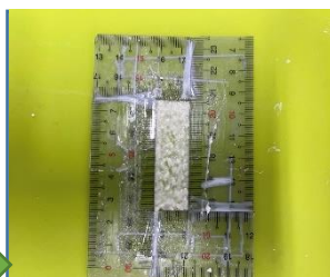
照片 17 將製作好的牛奶膠水用模具平鋪在矽膠墊上
