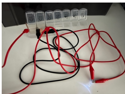
▲圖十九 串聯 2 個伏打電池 (運用 5ml 的和平島海水)
