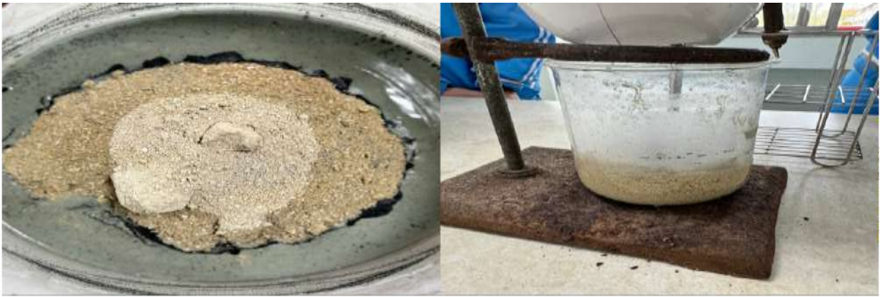
圖 4-2. 氧化鈣與水 (CaO/H 2 O) 配置比例為 1:1 時之水泥製備情形。
