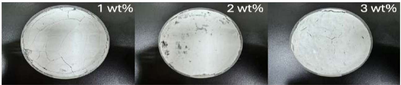
圖 4-7.不同比例的奈米纖維素結合牡蠣殼水泥灌模乾燥後之情形。
