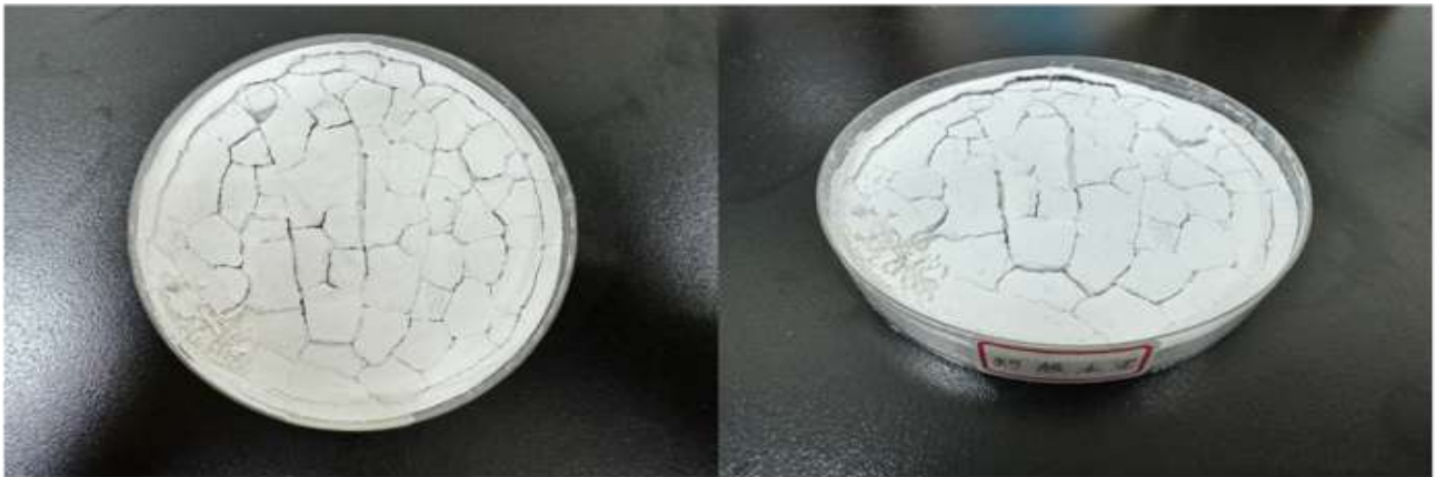
圖 4-3. 利用牡蠣殼水泥灌模之乾燥後觀察。
