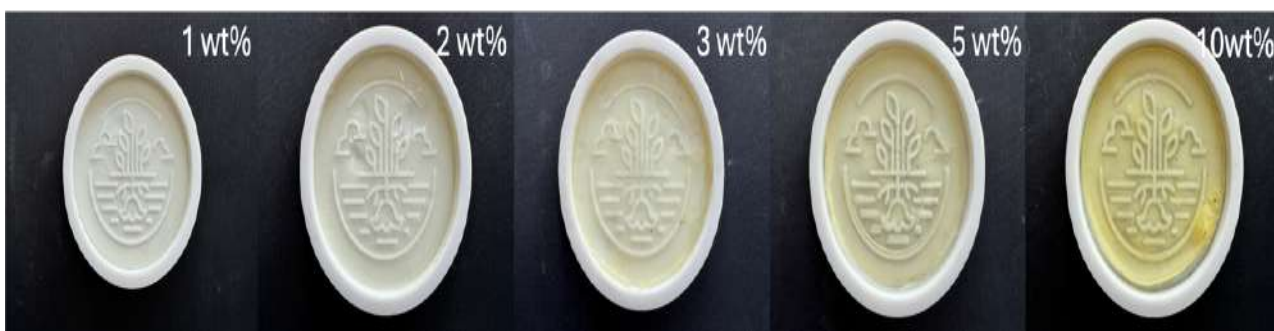
圖 4-6.不同比例下的奈米纖維素灌模乾燥後之觀察。
