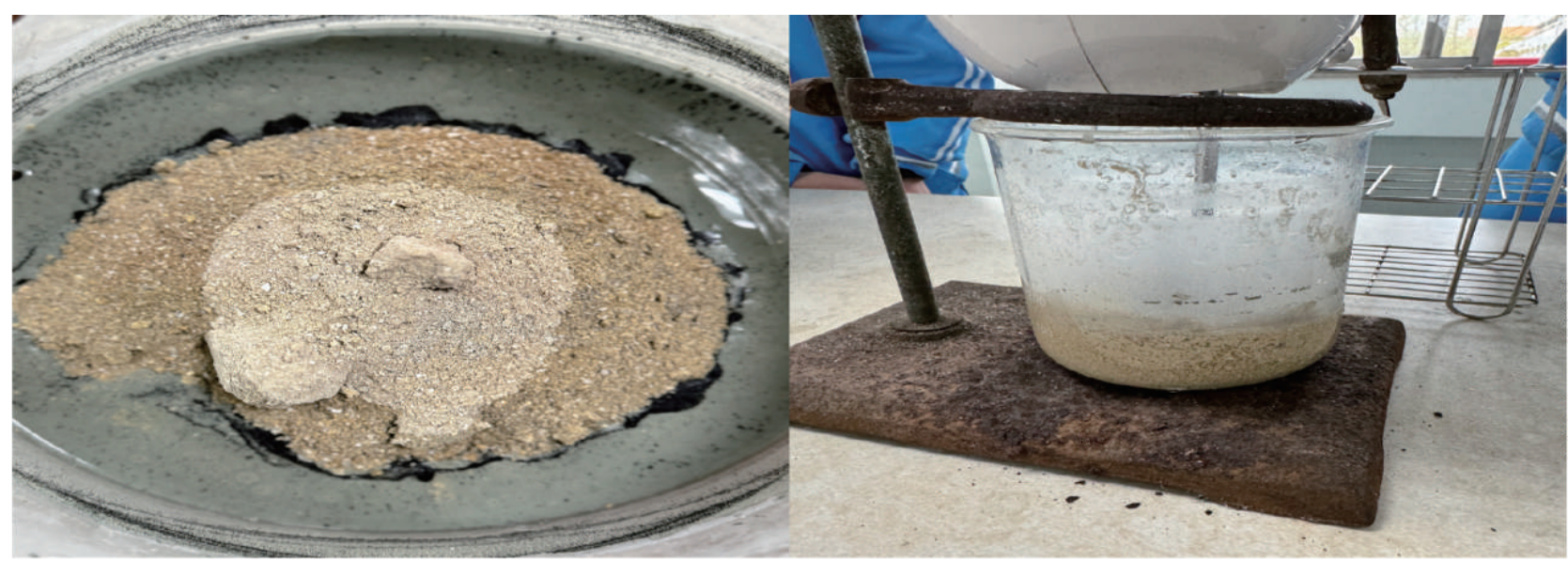
圖4-2.氧化鈣與水(CaO/H 2 O)配置比例為1:1時之水泥製備情形(資料來源：出自於指導老師所繪製)
