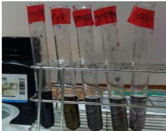
圖6 沒食子酸鐵離子檢量線實驗照片(作者拍攝)
