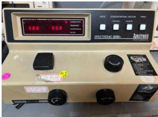
圖4分光光度光計 實驗照片(作者拍攝)
