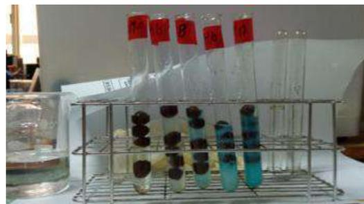
圖13 不同濃度銅離子溶液+發泡煉石實驗照片(作者拍攝)
