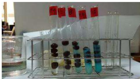
圖38 銅離子溶液添加牡蠣殼發泡煉石後，在不同pH值的吸收度(作者拍攝)
