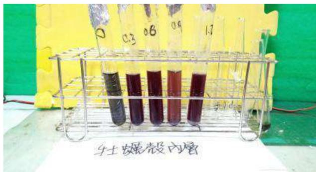
圖10 內層蠣殼+不同鐵離子濃度溶液實驗照(作者拍攝)
