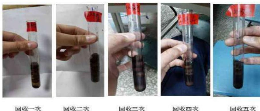
圖40 不同回收次數的鐵離子溶液照片(作者拍攝)
