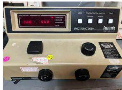
圖8 分光光度計實驗照片(作者拍攝)
