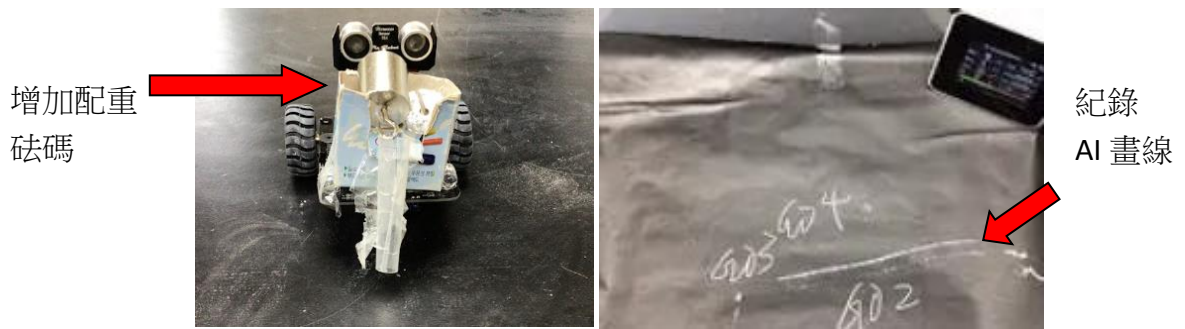
圖十七 智慧小車上增加配重砝碼，以智慧小車取代人工書寫
