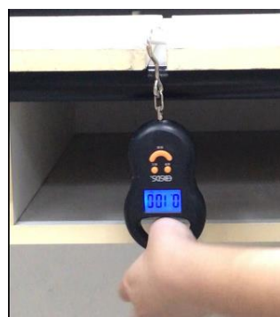
圖六 粉筆抗變性測量：用電子拉秤測量拉斷掛在兩桌中的粉筆所需外力
