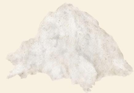
本研究想了解利用馬祖天然的廢棄淡菜殼，回收再利用，將淡菜殼透過高溫鍛燒，研磨製成淡菜殼粉，淡菜殼中富含碳酸鈣，依不同比例，研發製作最佳比例的自熱包，並探討不同鍛燒溫度淡菜殼所製成的自熱包之溫度變化，及與市售自熱包的差異性。若能將這些廢棄的淡菜殼，變身為多元用途，不僅可解決廢殼堆棄所造成的環保問題，使淡菜殼的利用更趨多元化，同時也可提昇淡菜殼的附加價值。
