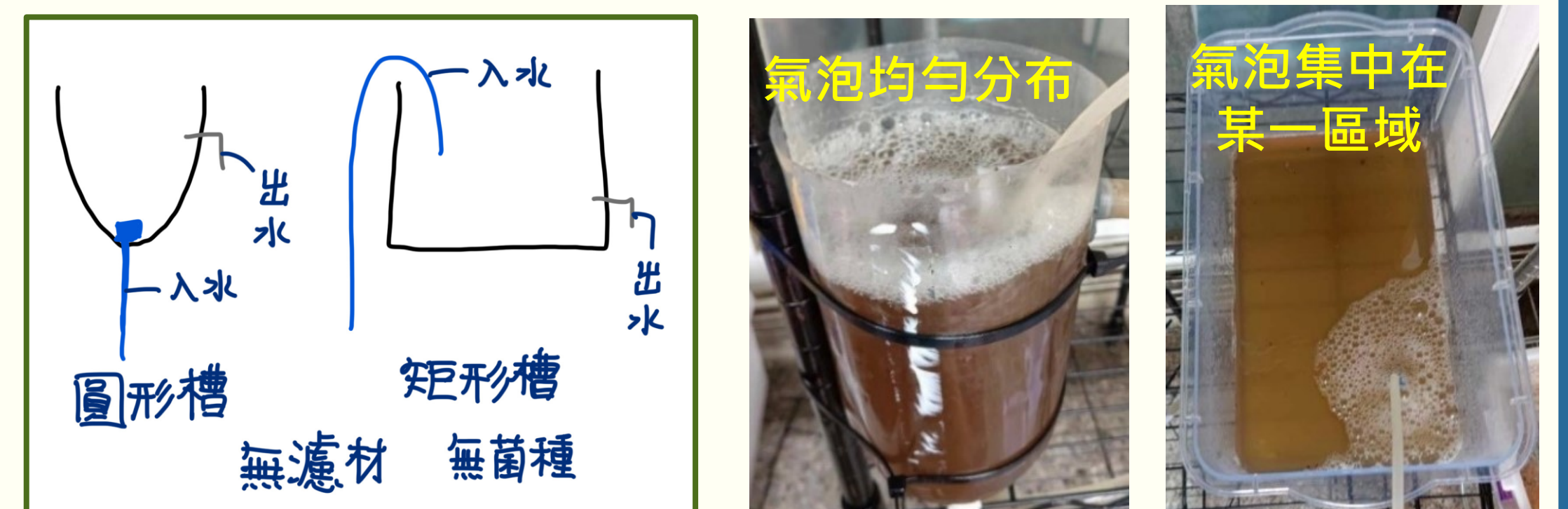
▼曝氣槽裝置示意圖與實際裝置圖(圖片與照片來源：作者親自繪製與拍攝)
