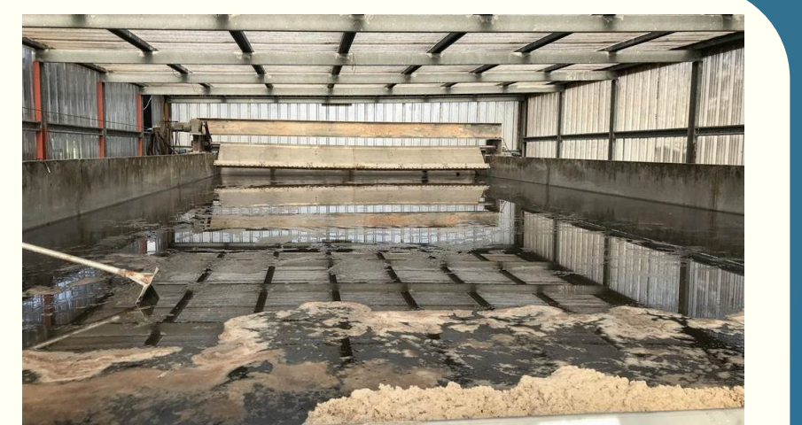
▲國立中興大學研發設計「隧道式日照蒸發結晶設施」解決酸菜醃漬廢水處理問題(圖片來源：中時新聞(周書聖攝))
