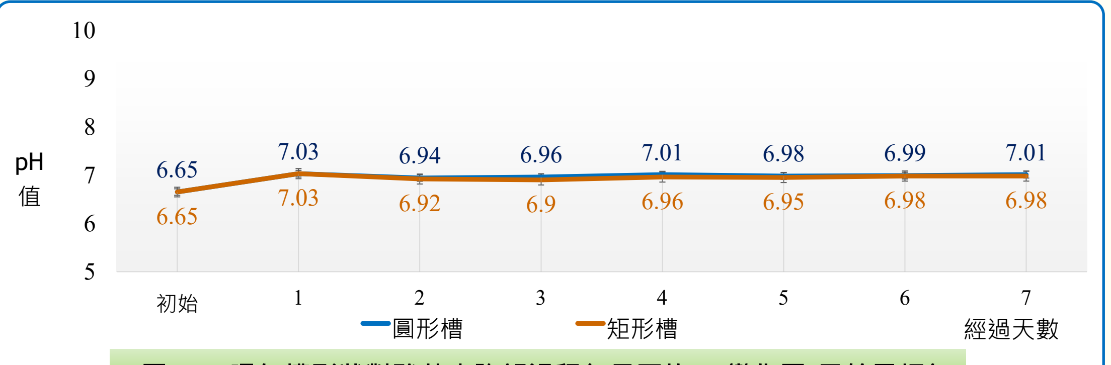
▲圖一.1 曝氣槽形狀對酸菜水降解過程每日平均pH變化圖(只給予打氣)
