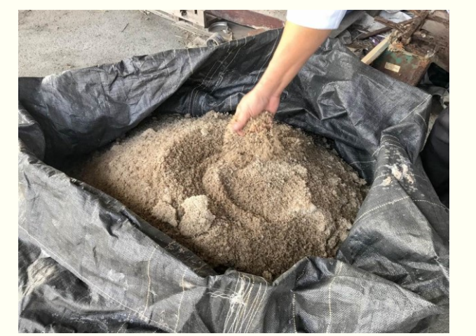
▲酸菜醃漬廢水經過「隧道式日照蒸發結晶設施」所產生的結晶鹽(圖片來源：中時新聞(周書聖攝))
