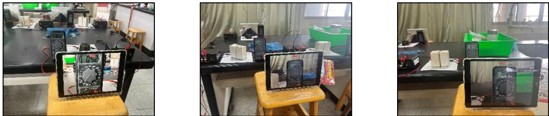
圖 3-3-7-3 自製電池在充電後放電的實測錄影(由左至右依序為充電 5、10、15 分鐘) (照片皆由第一作者拍攝)
