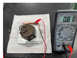
圖 3-3-5-1 測試自製電池的放電效益 (此照片由第二作者拍攝)
