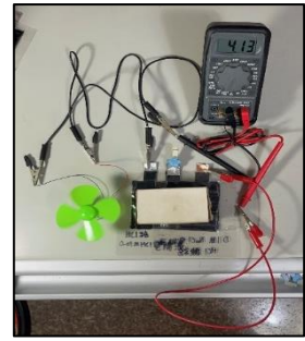
圖 3-3-7-5 自製電池的實測過程 (照片由第二作者拍攝)
