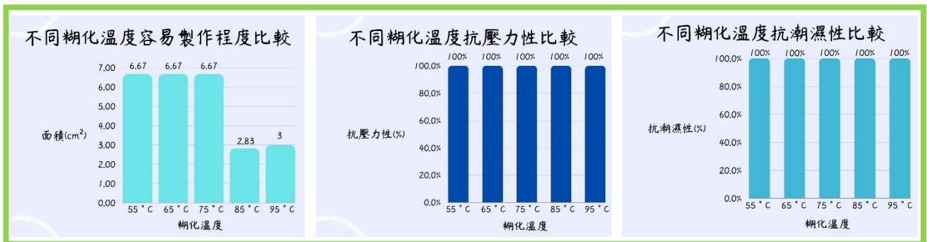
圖14、不同糊化溫度製成的藥物包裝紙容易製作程度、抗壓力性與抗潮濕性比較圖
