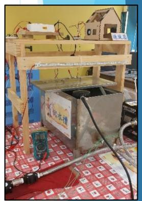
水輪發電機實體圖與綠電應用示例 (圖片引用：作者自行拍攝)
