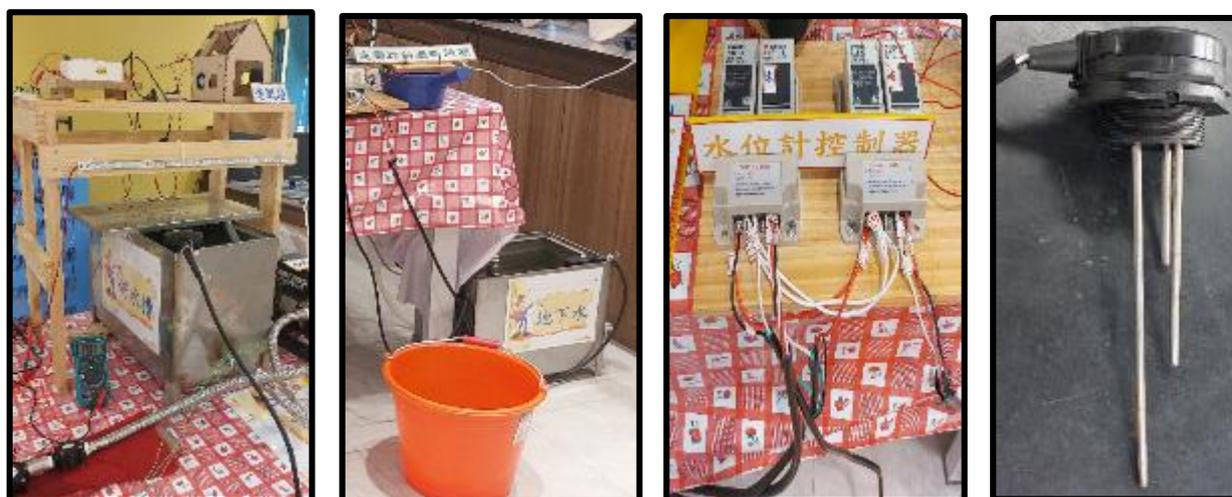
圖 7：儲水槽與地下水儲水槽水位實體圖 (圖表引用：作者自行拍攝)
