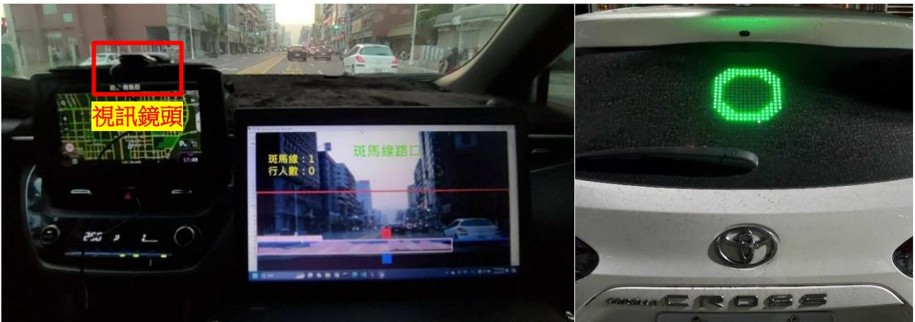
(a) (行人警示系統只偵測到斑馬線→畫面顯示”斑馬線路口”→後方警示燈點亮”綠色圓圈”)
