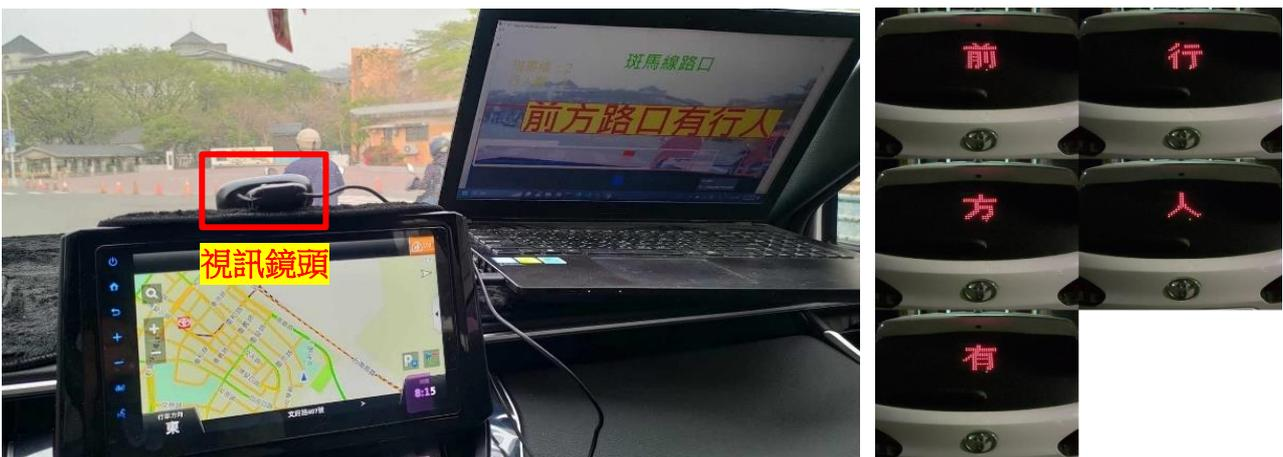
(c) (同時偵測到行人與斑馬線→畫面顯示”前方路口有行人”→後方警示燈點亮”前方有行人”)
