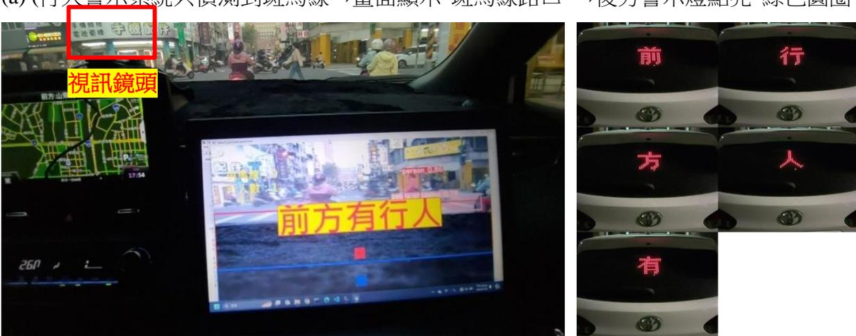
(b) (行人警示系統只偵測到行人→畫面顯示”前方有行人”→後方警示燈點亮”前方有行人”)
