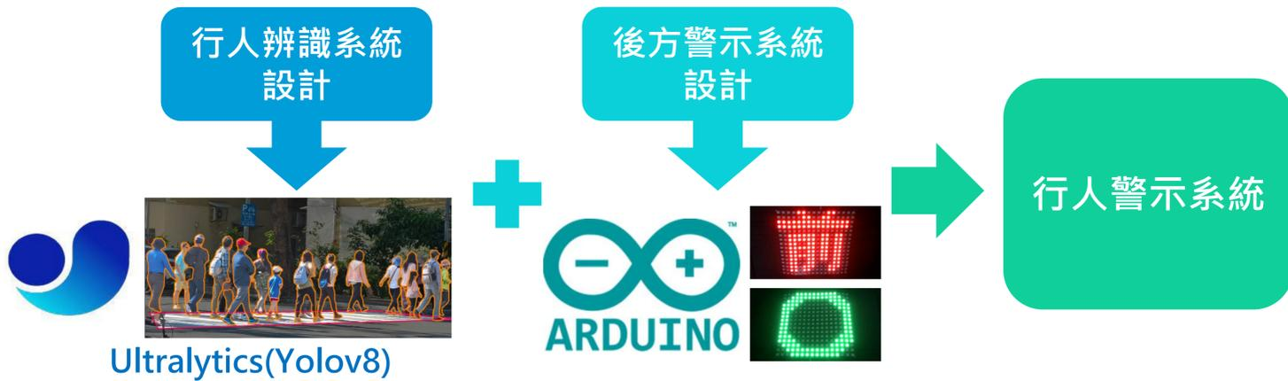
將這兩個概念結合，使用Yolov8進行斑馬線與行人的影像辨識，透過藍芽訊號將辨識結果傳送至後方警示系統，就開發出一個可以即時提醒駕駛並同時告知後方來車的警示裝置，我們稱此裝置為『行人警示系統』。開發出『行人警示系統』，是我們做這個研究最大目的。
