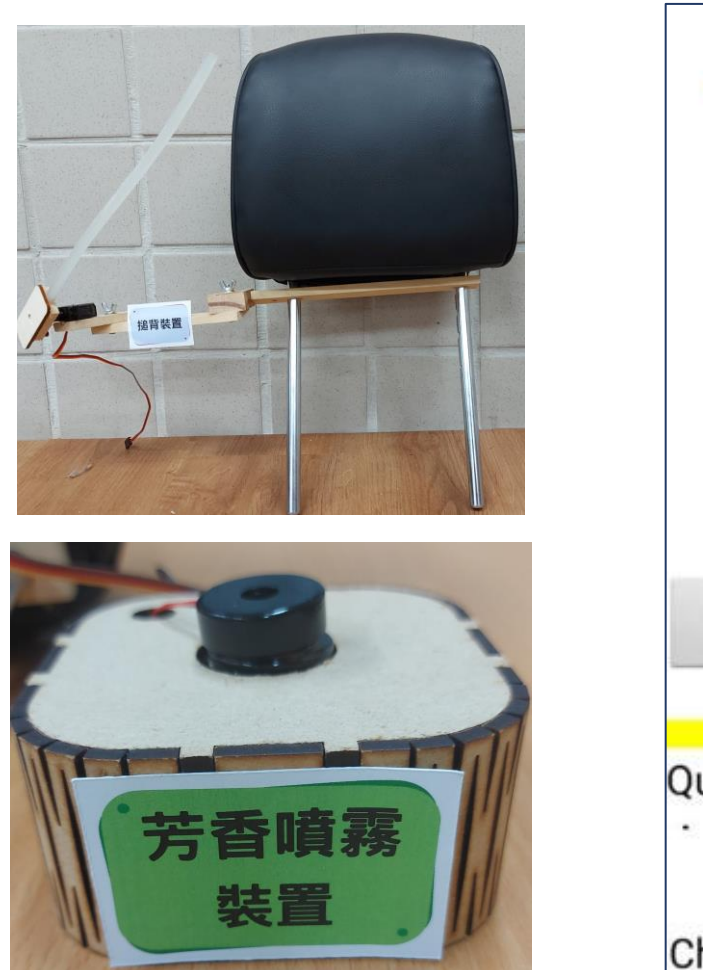
圖4-3 行車模式-「疲勞偵測」香氛提神裝置及拋背提神裝置 (本照片為作者自攝)
