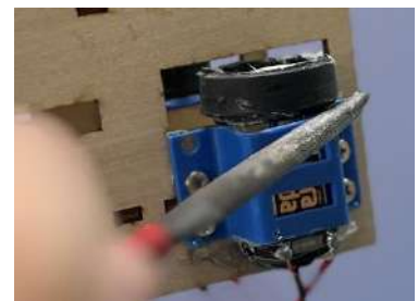
圖 37 滾輪旋轉時卡到馬達架，以銼刀打磨馬達架(本圖由作者拍攝)
