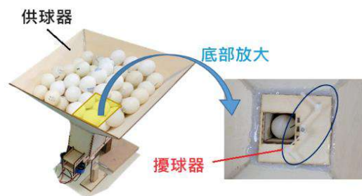
圖 36 加大容積供球裝置與擾球器 (本圖由作者拍攝)
