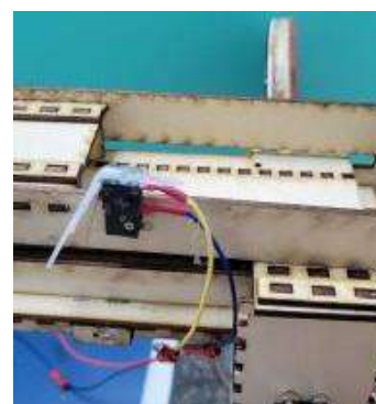
圖 40 利用塑膠束帶避免滑塊來回撞擊微動開關(本圖由作者拍攝)
