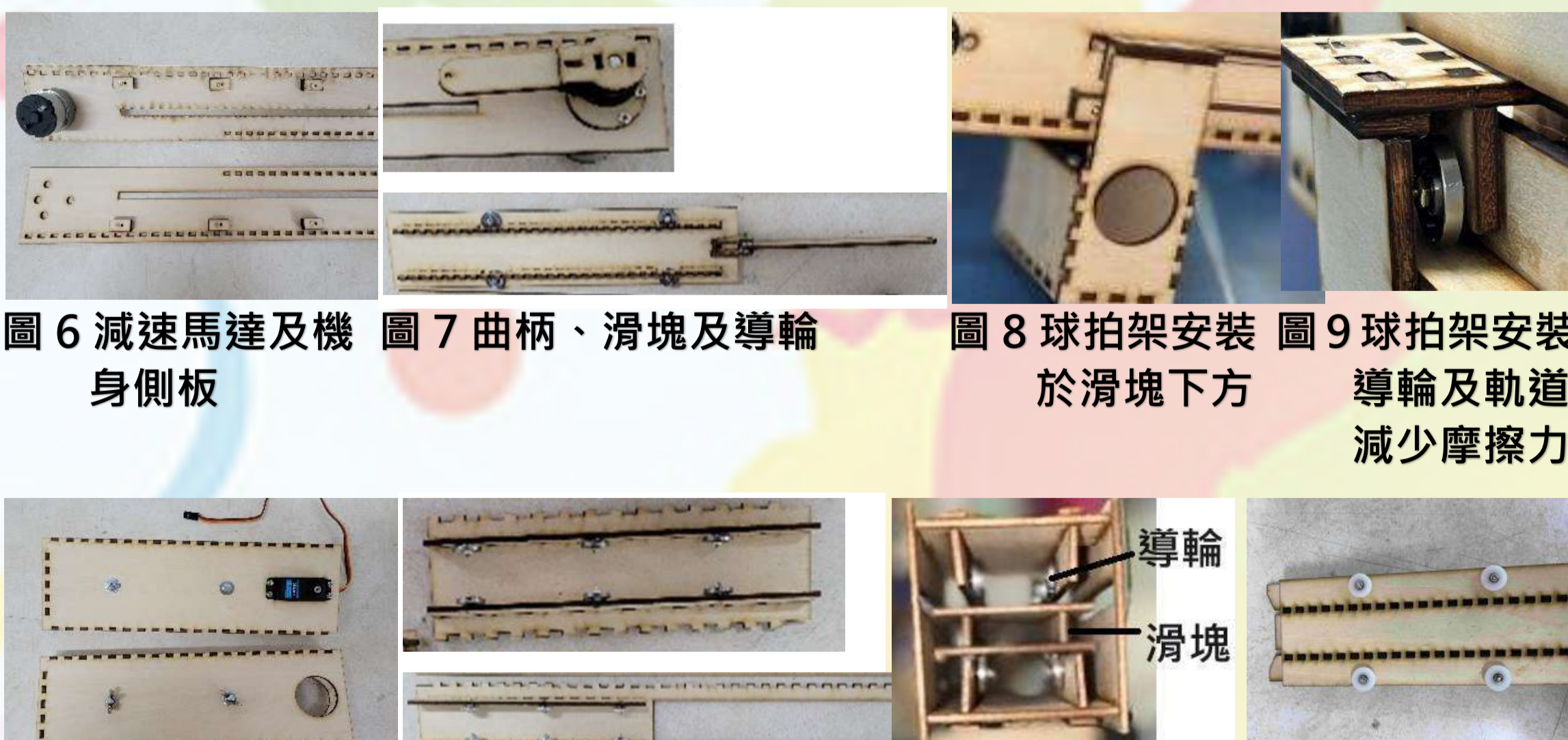
圖 6 減速馬達及機身側板 圖 7 曲柄、滑塊及導輪 圖 8 球拍架安裝於滑塊下方 圖 9 球拍架安裝導輪及軌道減少摩擦力 圖 10 擊球仰角控制腳架 圖 11 上蓋板及下底板加裝導輪 圖 12 上下底板裝導輪讓滑順利滑動 圖 13 滑塊二側安裝導輪減少與機身側板間摩擦力
