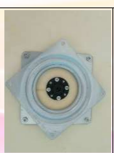
圖 23 平台上轉盤加裝滾珠轉盤
