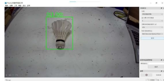
利用Teachable Machine建立羽毛球的影像模型，搭配Pixetto的鏡頭，將拍攝學習後的模型匯入Pixetto軟體後即可辨識。
