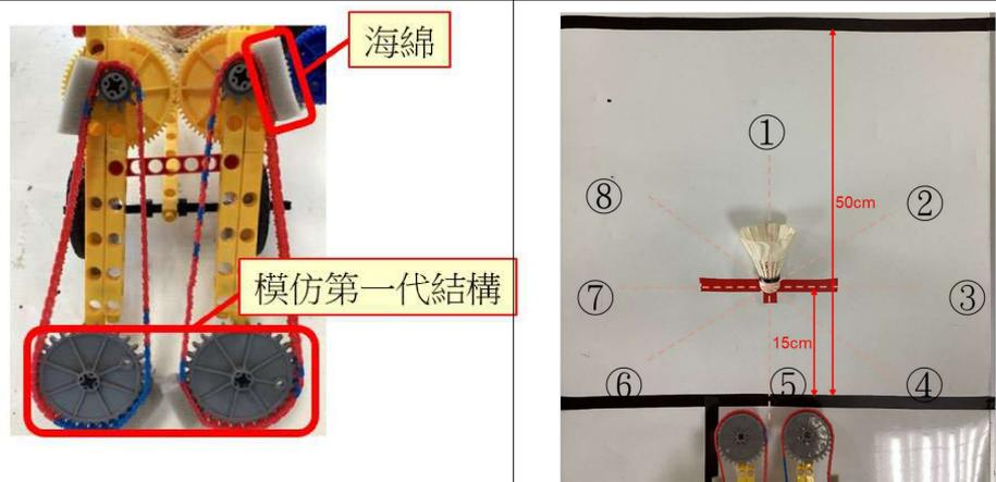
馬達旋轉齒輪透過鍊條帶動前方的大齒輪轉動。鍊條上有灰色海綿可將球向內轉入裝置中。
