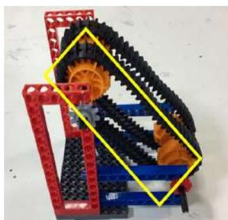
我們發現紅藍鍊條與束線帶容易不小心勾到羽毛球，導致羽毛球被捲入裝置進而傷害羽毛並影響裝置運作。於是我們又嘗試使用矽膠材質的鍊條，它比塑膠鍊條更柔軟，羽毛球在上升不容易勾住。
