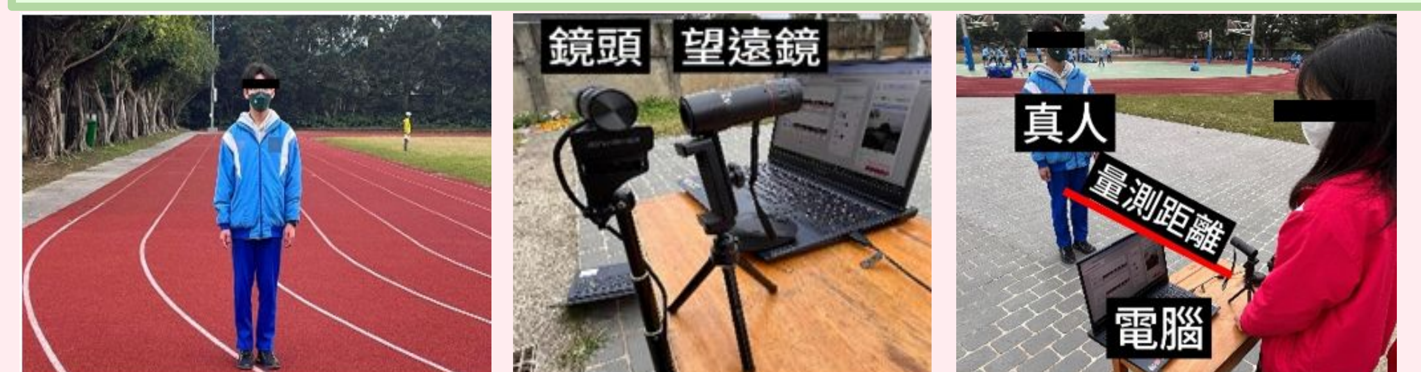
人穿藍色衣褲在跑道上 鏡頭結合望遠鏡 在信心值>90%之下，記錄不同距離人被偵測到信心值
