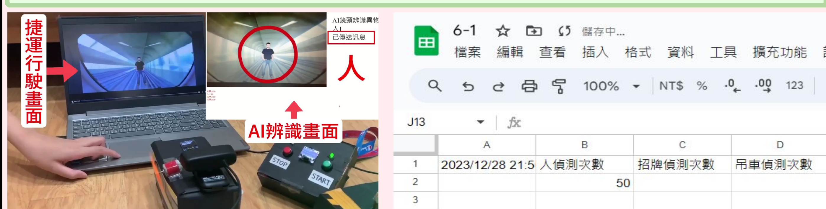
用AI模型偵測人、招牌、吊車，隨機出現50次的影片
