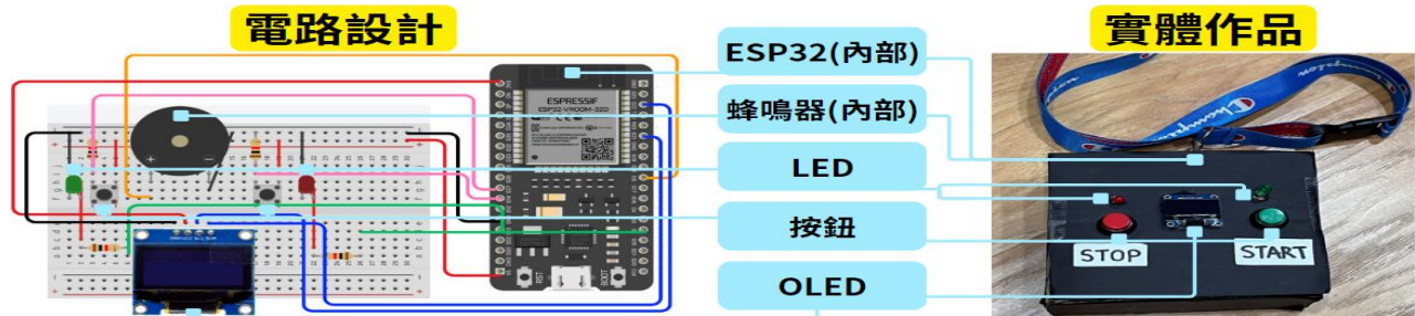
圖 3-4-17 隨車員煞車裝置硬體設計圖
