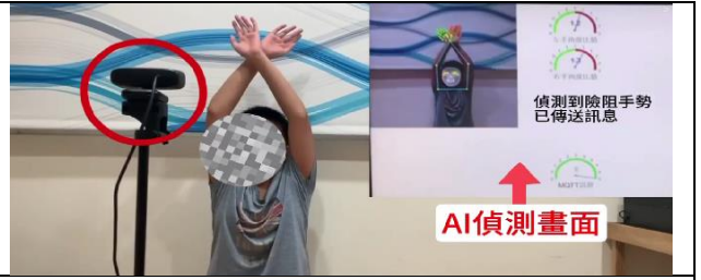
圖 3-4-12 測試 MediaPipe Holistic 姿態辨識程式是否能順利辨識險阻手勢，並傳送 MQTT 訊息
