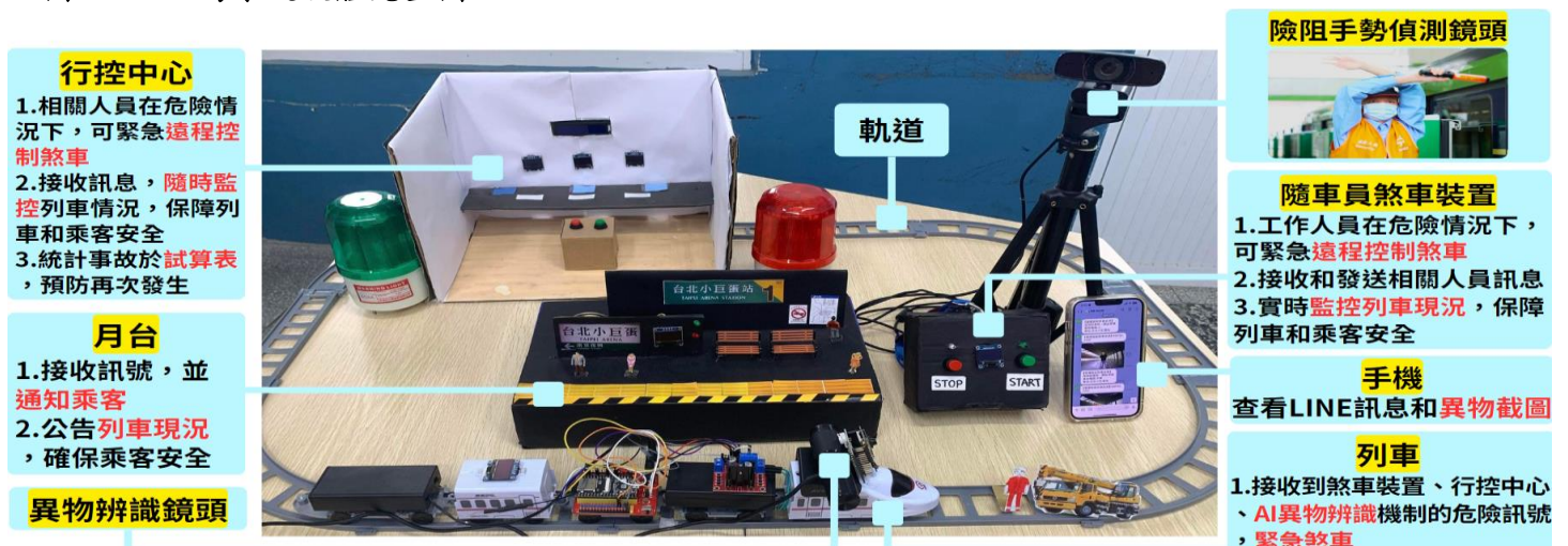
圖 3-4-19 捷運 AI 異物辨識及智能煞車輔助系統硬體完整圖
