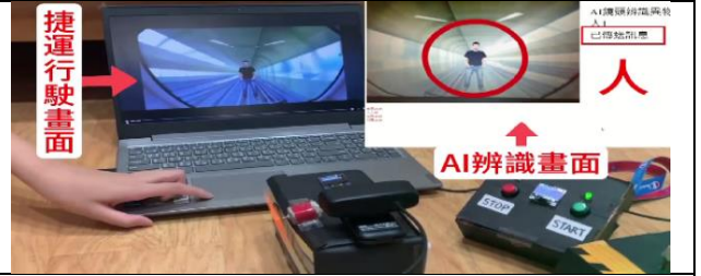
圖 3-4-14 測試 Google Teachable Machine AI 異物辨識程式是否能順利辨識異物，並傳送 MQTT 訊息
