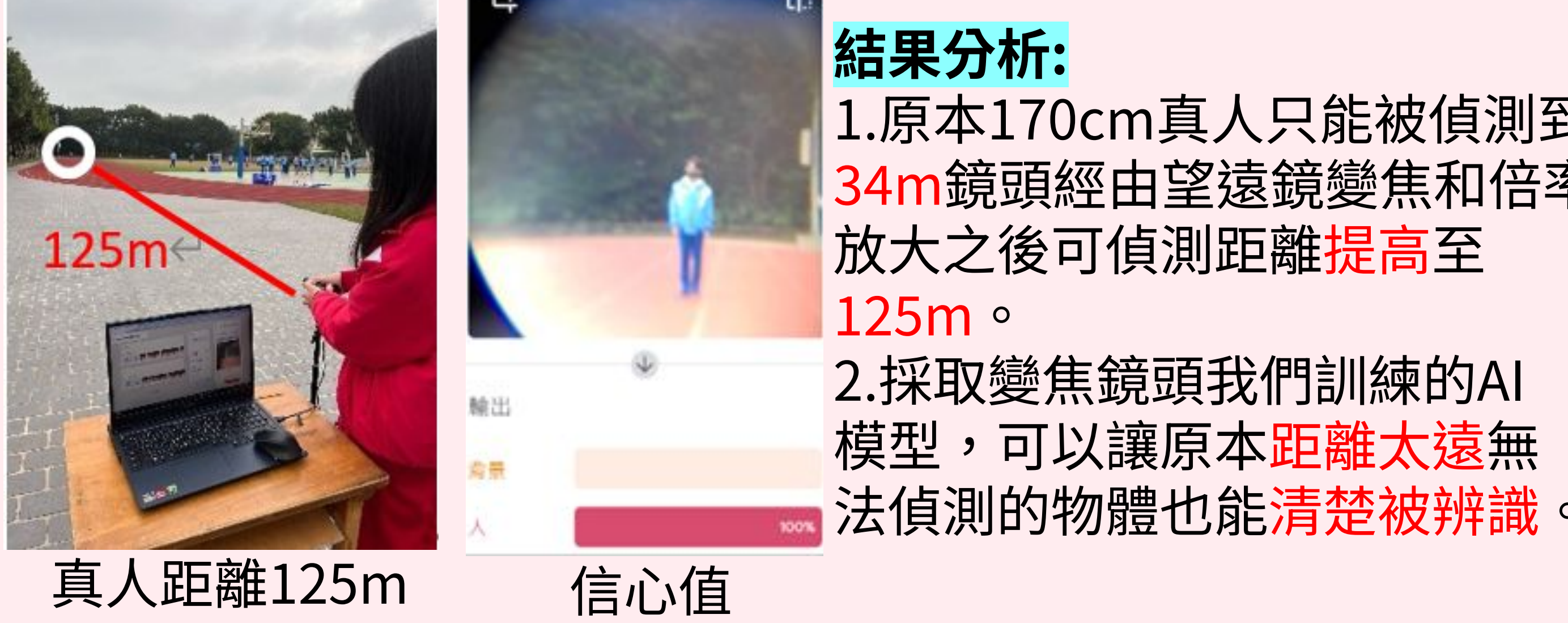
人穿藍色衣褲在跑道上 鏡頭結合望遠鏡 在信心值>90%之下，記錄不同距離人被偵測到信心值
