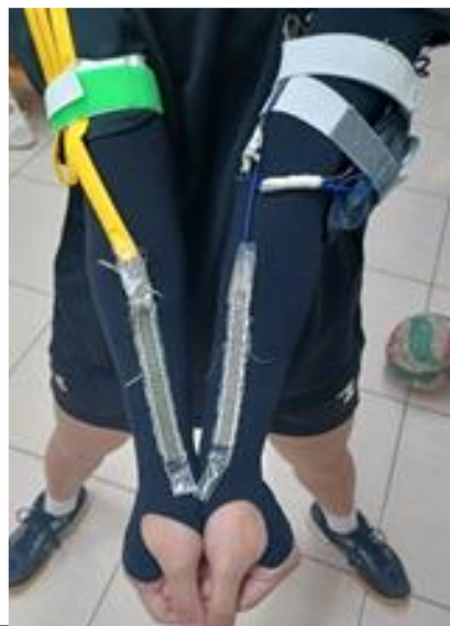
圖三十八:低手傳球感測袖套展示圖 (第一作者拍攝)
