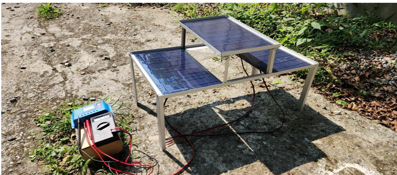
▲圖 7、測試單一太陽能板發電功率實驗
