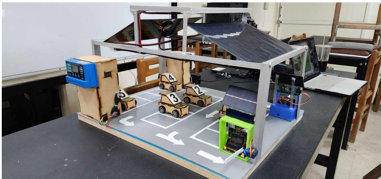
▲圖 29、計算太陽能供電於電池備載電力與滿載充電測試的實驗
