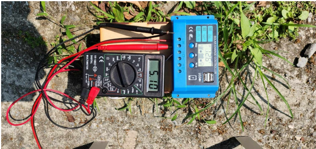
▲圖 8、測試單一太陽能板發電功率實驗
