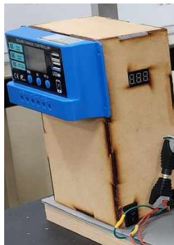
▲圖 9、計算太陽能供電於電池備載電力與滿載充電測試實驗
