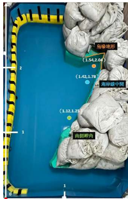
圖 3-3-4、塑膠墊堆成沙崙海水浴場模型 模組監測位置圖（作者拍攝）
