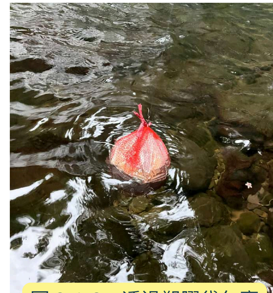
圖 3-1-2、透過塑膠袋包裹模組作為防水措施
