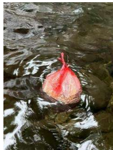
圖 3-1-2、透過塑膠袋包裹模組作為防水措施（作者拍攝）
