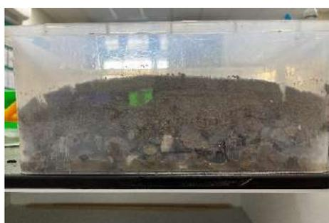
圖 48 細砂礫石層實驗後兩側地層下陷 (研究者自行拍攝)
