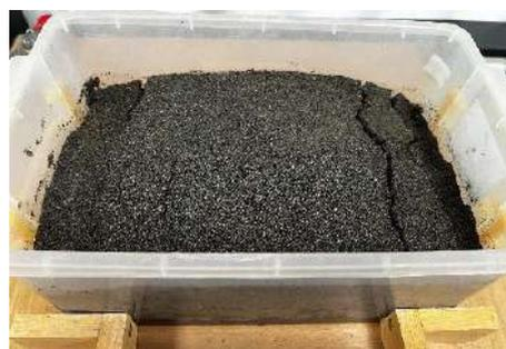
圖 49 細砂礫石層實驗後地表龜裂 (研究者自行拍攝)
