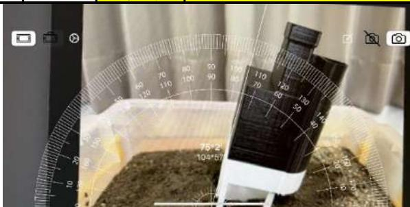
圖 57 軟腳蝦大樓震度 6 級實驗後傾斜 15 度 (研究者自行拍攝)
