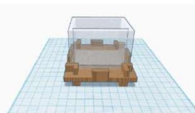
圖 4 自製固定底座設計圖
