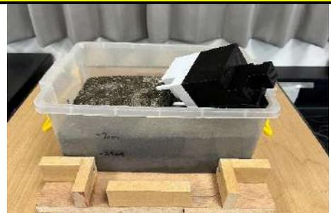
圖 58 軟腳蝦大樓 7 級實驗後倒塌 (研究者自行拍攝)
