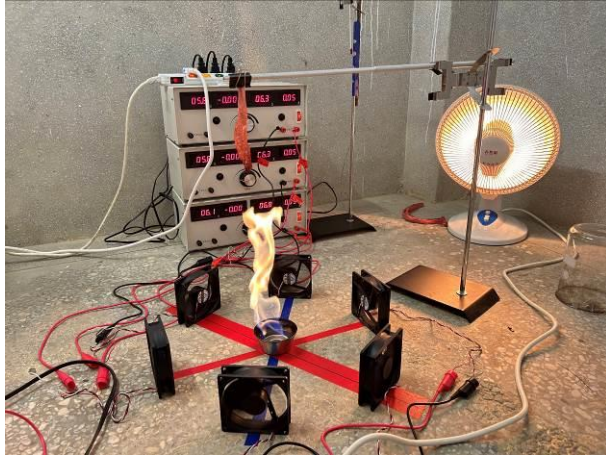
▲暖房實驗一：抽風扇正對鐵杯中心、無歪斜
