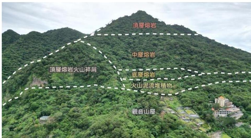
圖 21 地質圖修改之結果 (作者繪製，底圖為作者拍攝空拍圖)
