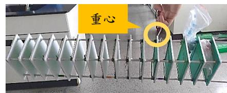
圖 14、懸吊法找重心-鋼骨建築
