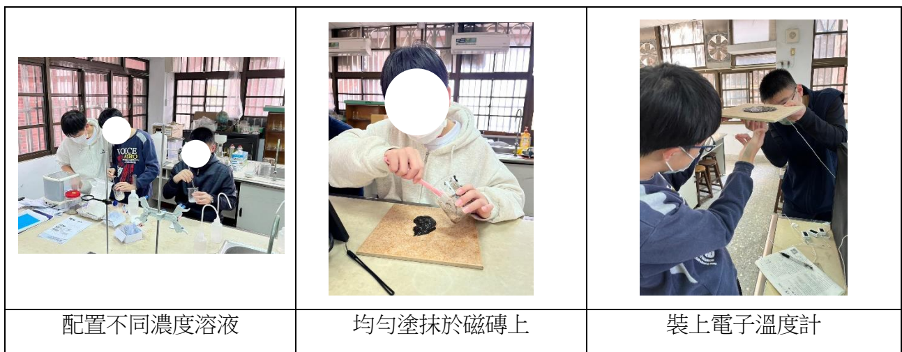
圖九、隔熱效果檢測之實驗步驟(指導老師拍攝)
