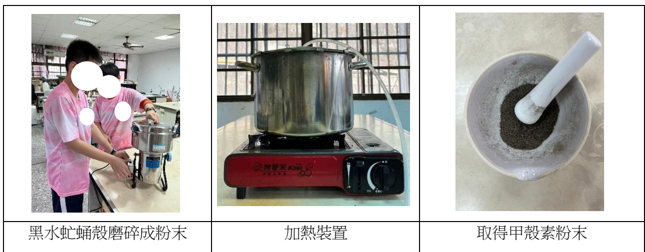
圖八、萃取黑水虻蛹殼甲殼素之實驗步驟(作者拍攝)
