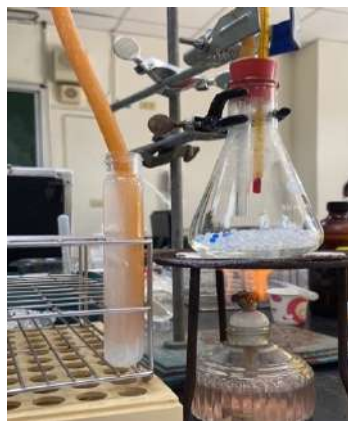
▲圖 7.以澄清石灰水檢測脫附 CO 2 的實驗照片
