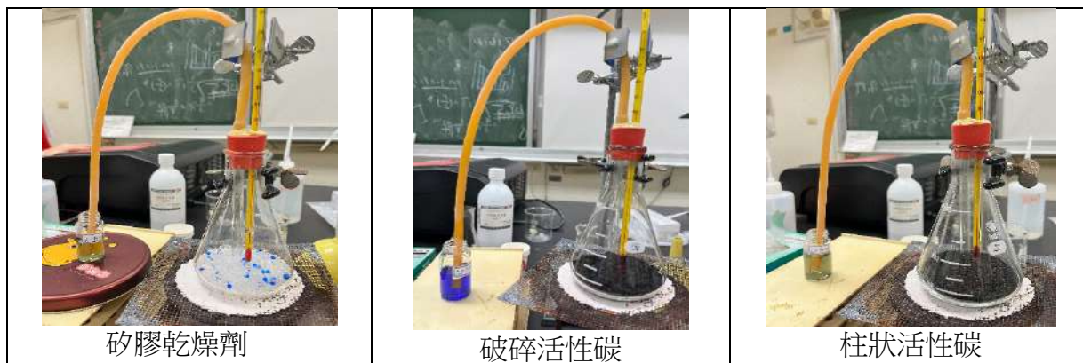
▲圖 9.以碳酸氫鹽指示劑檢測碳捕捉材料脫附 CO 2 的實驗裝置
