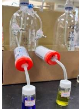
▲圖 6.自製二代氣瓶同時通氣於矽膠乾燥劑和保麗龍球照片
