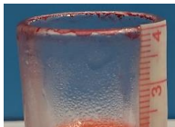
圖十九、丙酮實驗後，附著於杯壁外的小水滴
