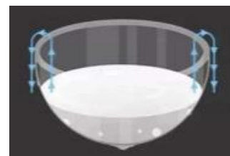
圖五、馬拉哥尼現象使液滴爬出杯外
