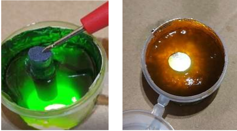
圖2 (左圖) 新鮮的葉綠素電池，在照光時會有氣泡在電極旁邊產生，(右圖) 變質的葉綠素電池，會有明顯的臭味且電壓與電流都會下降。
