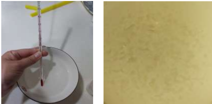
圖7 (左)微波加熱1分鐘後冷卻5分鐘後量測溶液，(右)肉眼可見未溶的寒天
