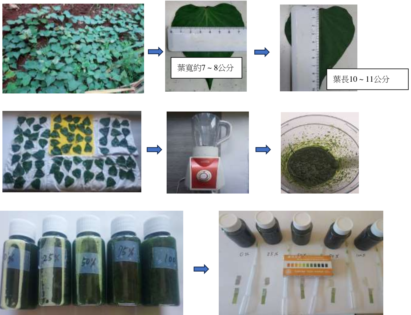
圖6 採集與萃取葉綠素溶液的實驗過程及量測溶液的pH值如圖所示。
