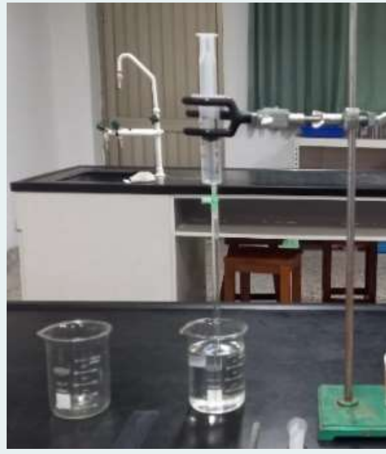
圖7 實驗裝置，注射筒內不放待測金屬，分別以空針筒、注入乾燥劑、注入脫氧劑。(自行拍攝)
