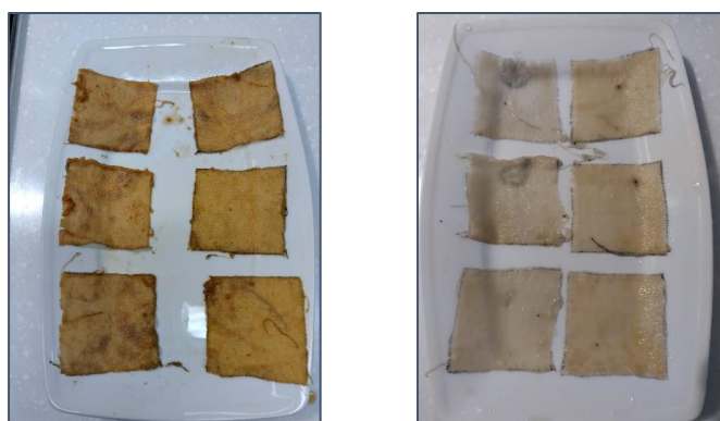
圖3-4-1-2 帶殼紅藜染布的初步測試，左為染布後未水洗，右為染布經水洗後 (以上照片由第一作者拍攝)
