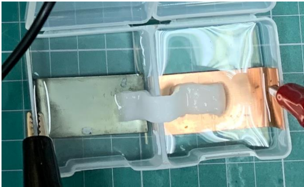
圖 6. 5ml 為接近可覆蓋鋅片、銅片的最低量（圖片來源：第二作者拍攝）
