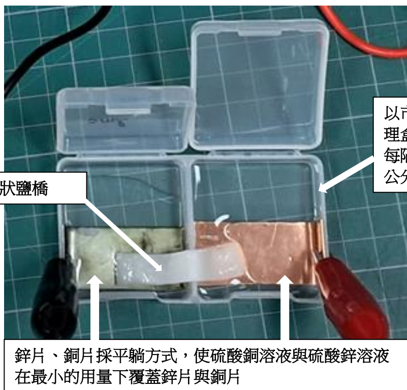
圖3.自行設計的微型鋅銅電池構造圖（圖片來源：第二作者拍攝）
