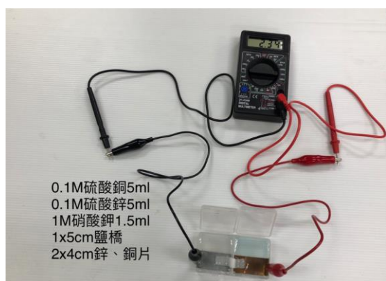
圖11. 藥品大幅減量的情況下即產生2.34mA的電流值（圖片來源：第二作者拍攝製作）
