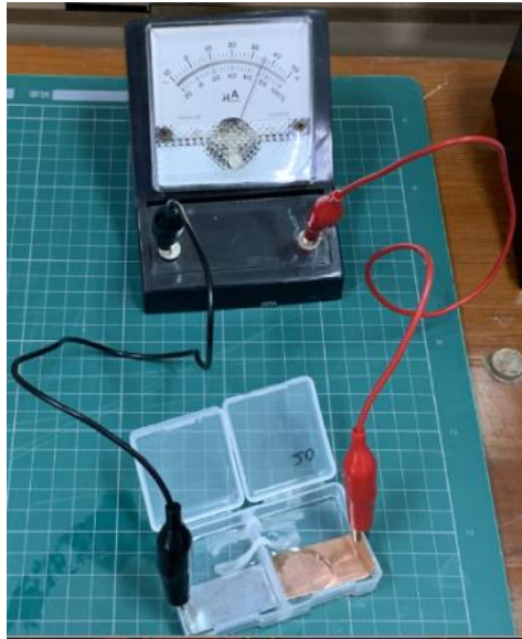
圖17. 低濃度與小鹽橋使微安培計能在測量範圍內運作良好
