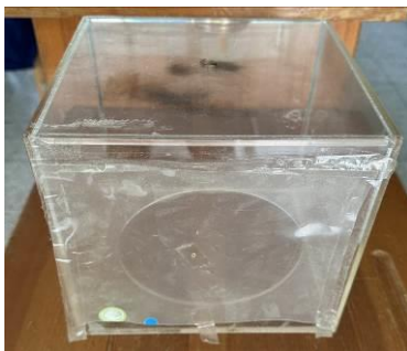
圖(七)實驗用密閉箱 (指導老師拍攝)
