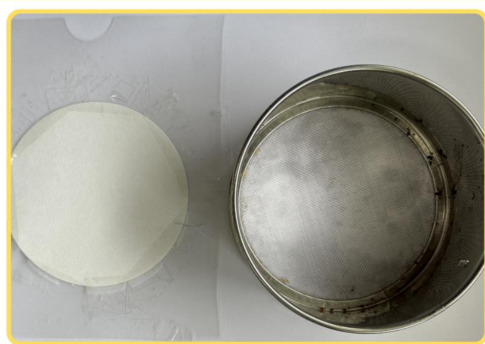
不同的濾網處理方式 左為濾紙模擬濾網 右為鐵絲篩網模擬濾網
