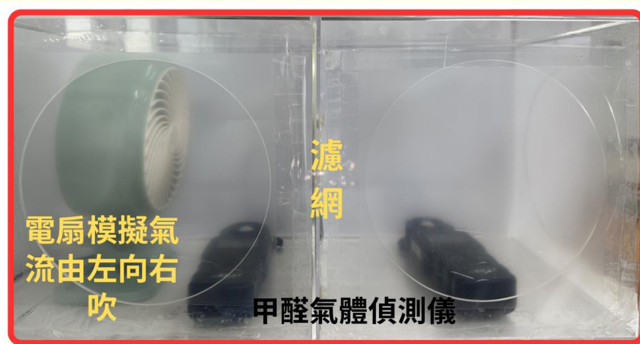
模擬簡易空氣清淨內部及密閉箱環境 測試甲醛空汙在通過濾網前後的數值變化
