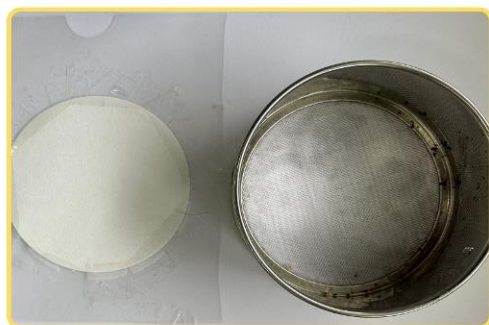
不同的濾網處理方式 左為濾紙模擬濾網 右為鐵絲篩網模擬濾網
