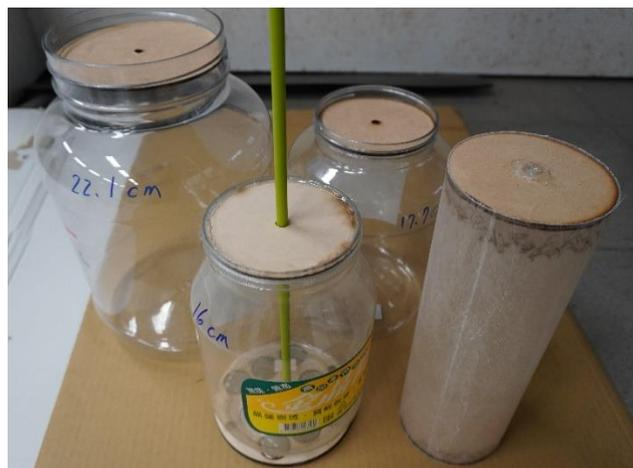
圖 9：各種口徑的振動阻體(照片由第 1 作者拍攝)
