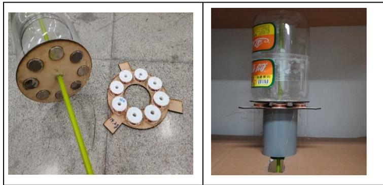
圖 14：改良版設計(a)強力磁鐵與線圈設計 (b)強力磁鐵與線圈組裝(照片由第 1 作者拍攝)
