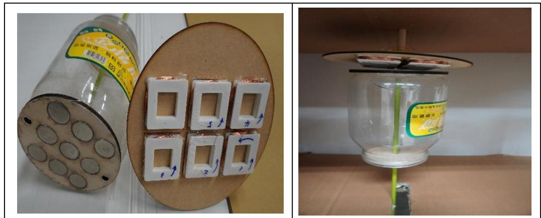
圖 13：最初設計(a)強力磁鐵與線圈設計 (b)強力磁鐵與線圈架設圖(照片由第 1 作者拍攝)
