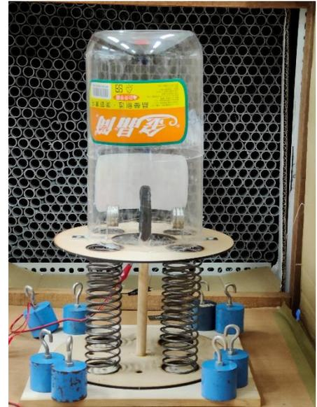
圖 16：彈簧振動阻體加發電裝置圖
