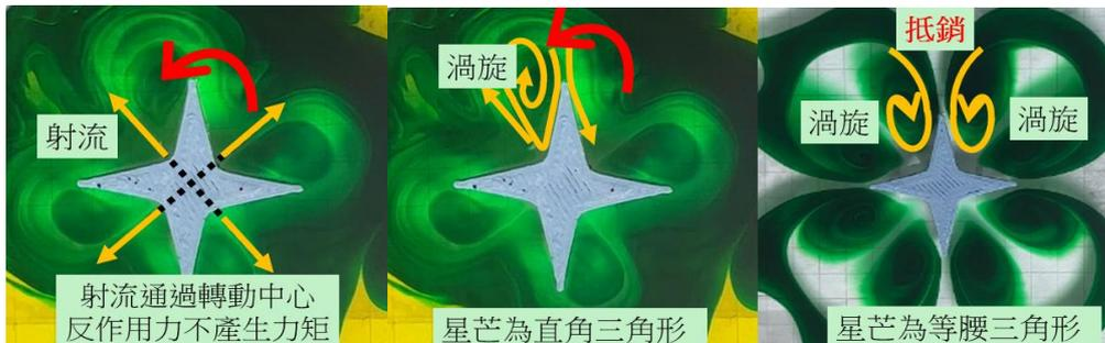
圖 6-5-2 星形射流與渦旋示意圖(二作繪)(紅線為漂體轉動方向，橘線為液體流動方向)
