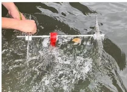
圖14 滑動式發電實際測試圖(照片由第一作者拍攝)
