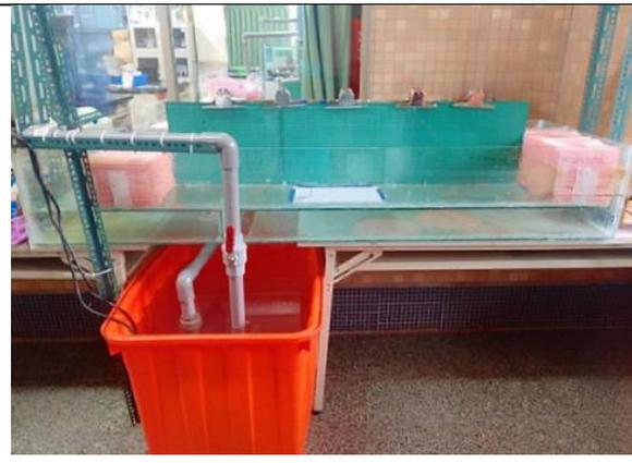
**圖7 急流循環水缸完成圖(擺盪式水流發電試驗)**
