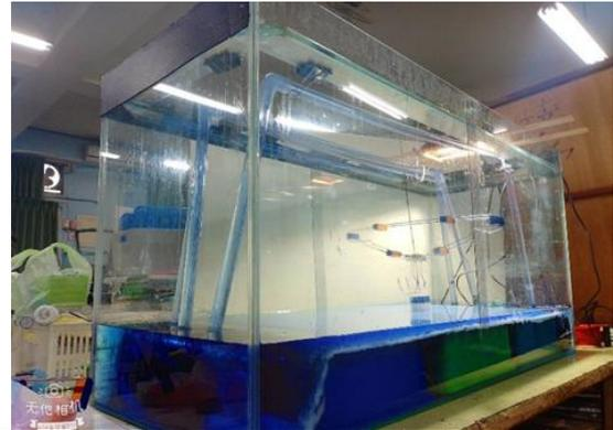
**圖5 緩流循環水缸完成圖(單擺渦流試驗)**
