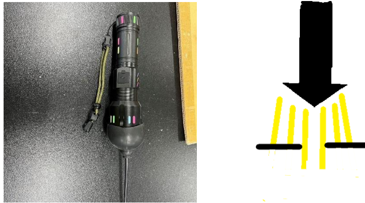
圖 3-5 測量光纖性質之裝置示意圖(左:作者自行拍攝；右:作者自行繪製)
