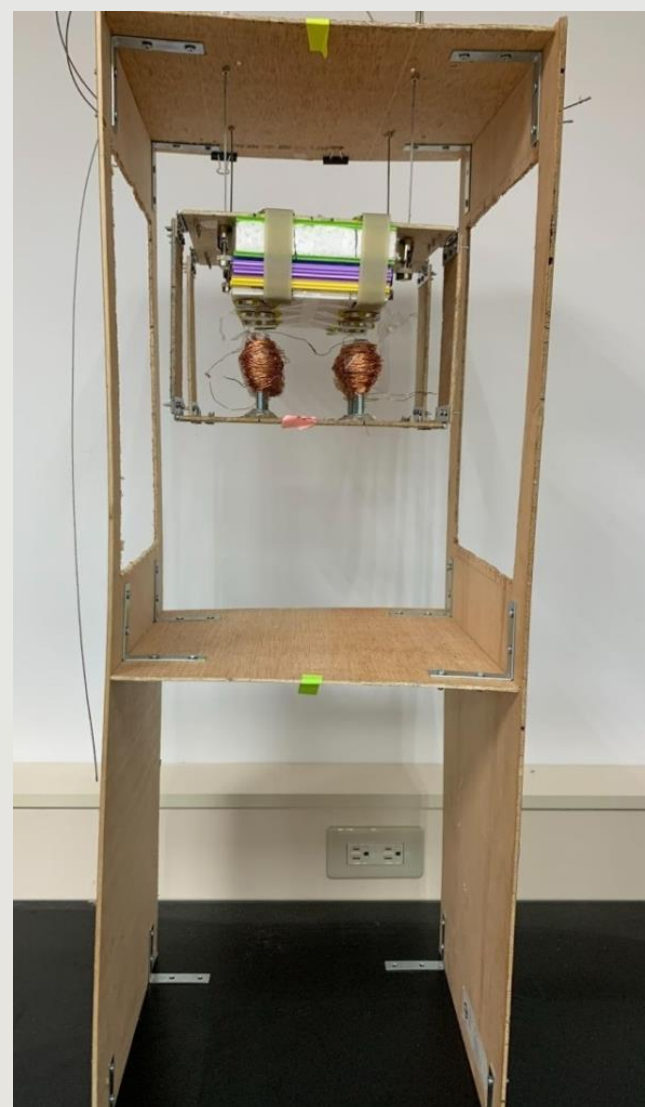
(圖三) 電磁類雙彈簧TMD建築
