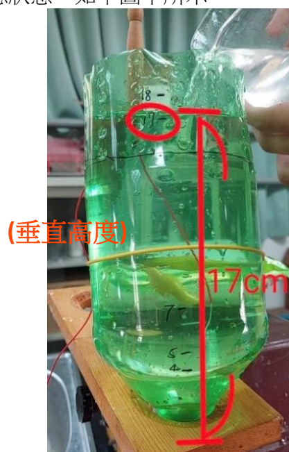
此項目照片皆由作者親自拍攝 圖 1-1，水壓定值示意
