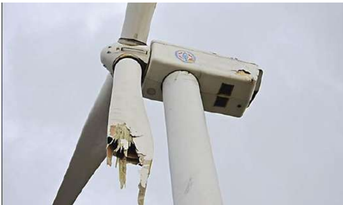
圖5-9-6風力發電機風扇斷裂(自由時報, 2013, 台電風機葉片斷落 躺沙灘逾半年)、 圖5-9-7卡門渦街發電裝置(第一指導教師親自拍攝)
