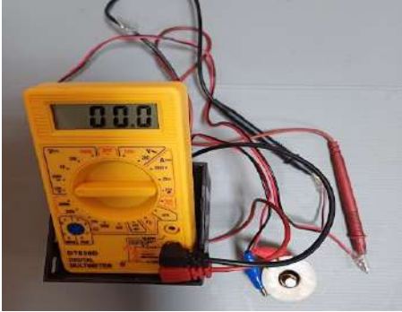
圖 5-9-1 卡門渦街發電實驗裝置 (第一作者親自拍攝)
