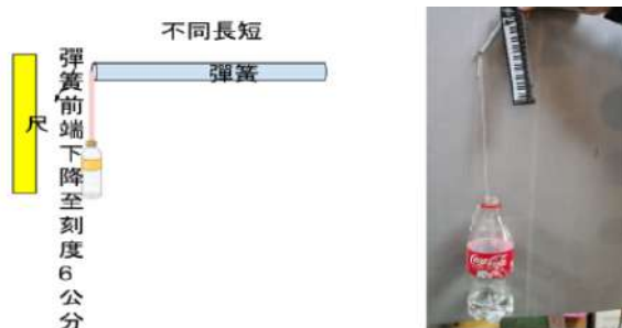
圖4-7-1彈簧彈性係數測量方法(作者親自拍攝、製作)
